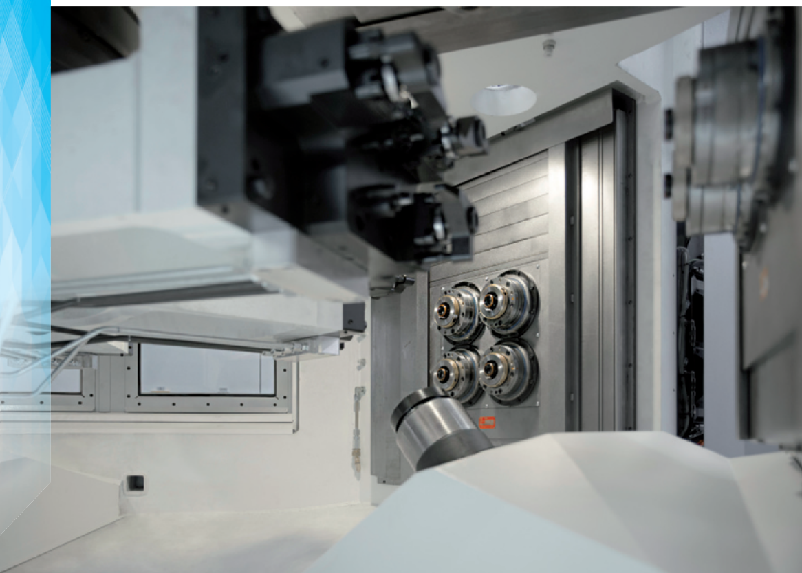
Un'unità modulare GT4 con i suoi quattro mandrini
