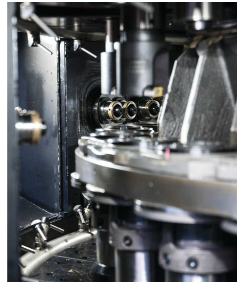
Piccola è estremamente flessibile e produttiva, in grado di eseguire operazioni di foratura, fresatura, filettatura e tornitura con pezzo statico o rotante.
